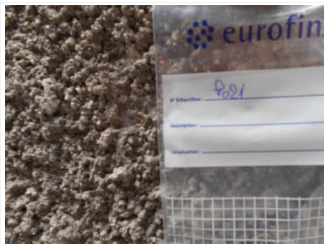
Composant : Enduits projetés 21 (N) P021 - Enduit projeté couleur gris foncé Enduit projeté localisé sur les murs de façades extérieures de la Maison d'Arrêt au point P021 (voir le plan de repérage)
