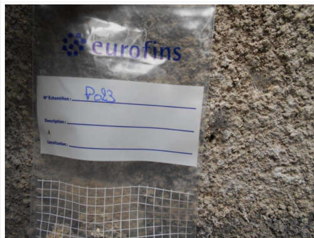
Composant : Enduits projetés 23 (N) P023 - Enduit projeté couleur gris foncé Enduit projeté localisé sur les murs de façades extérieures de la Maison d'Arrêt au point P023 (voir le plan de repérage)
